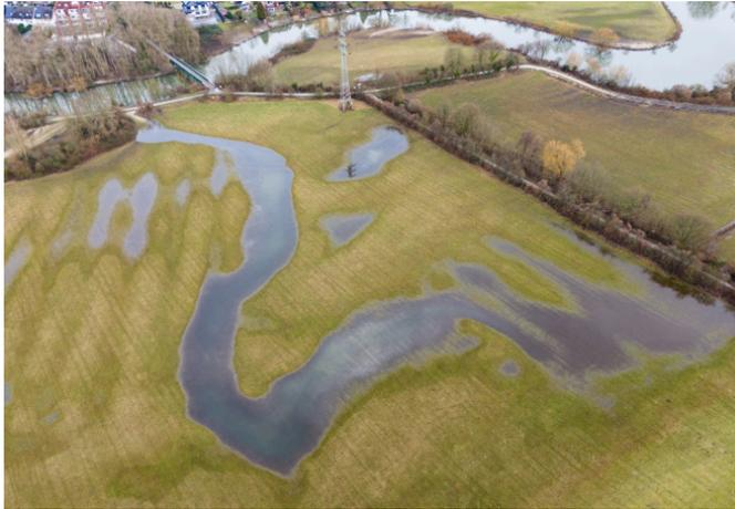
Drohnenaufnahme der Lippeaue im Bereich der Fischerhofbrücke Werne. Gut sichtbar ist die Geländevertiefung eines ehemaligen Bachlaufes in der Wiese südlich der Fußgängerbrücke. Weiterhin deutlich erkennbar sind Sandablagerungen an zwei Gleithängen. Quelle Kreis Unna – Fachbereich 62
