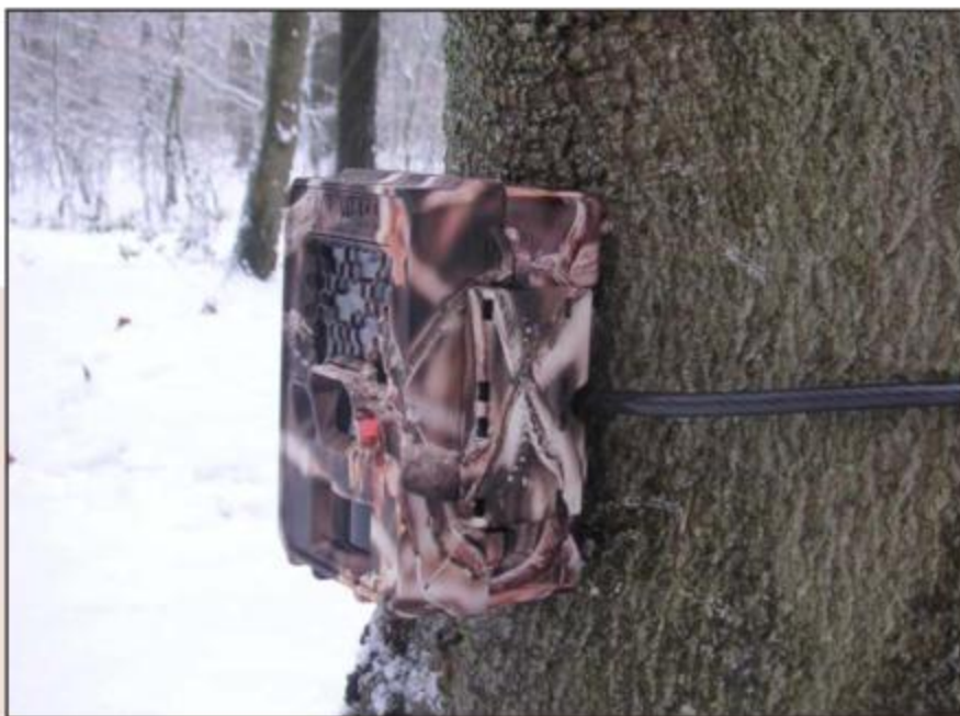
Abb. 72: Fotofalle im NSG Beversee, gegen Diebstahl mit Drahtseil und Schloß gesichert
